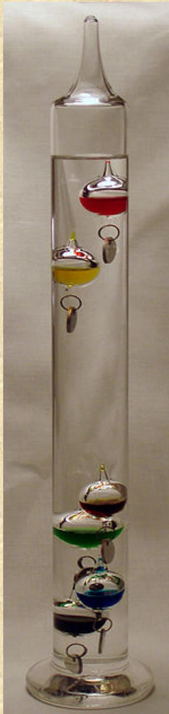
*O termômetro de Galileu. O seu funcionamento baseia-se na descoberta de que a densidade de um líquido, e logo também a força de impulsão por este exercida, depende da temperatura.*
