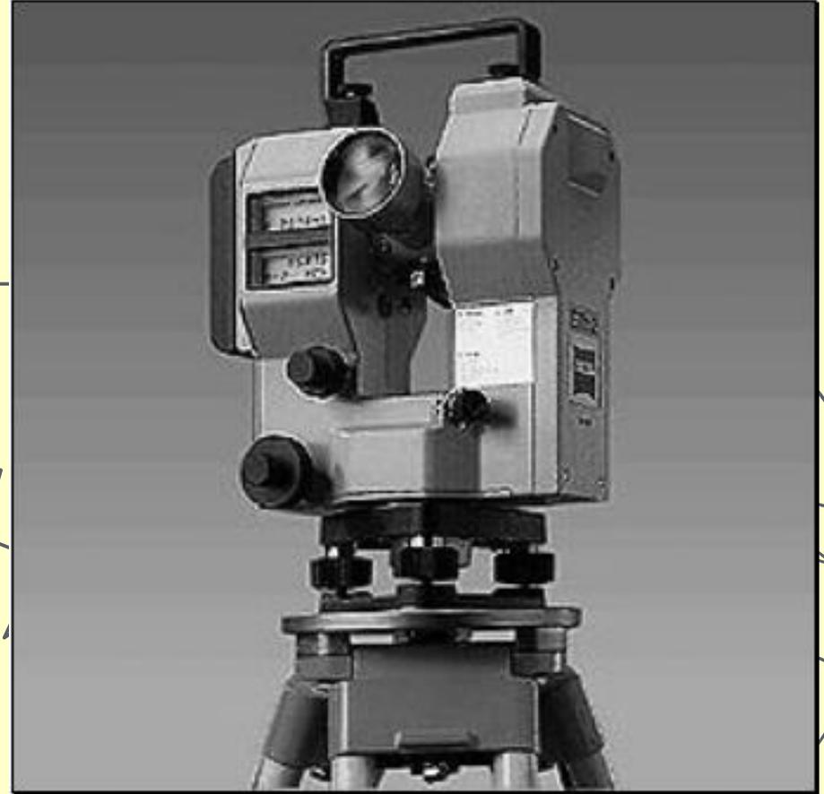
**Distanciômetros usados nos levantamentos de agrimensura, determinava indiretamente as distâncias horizontais.**
