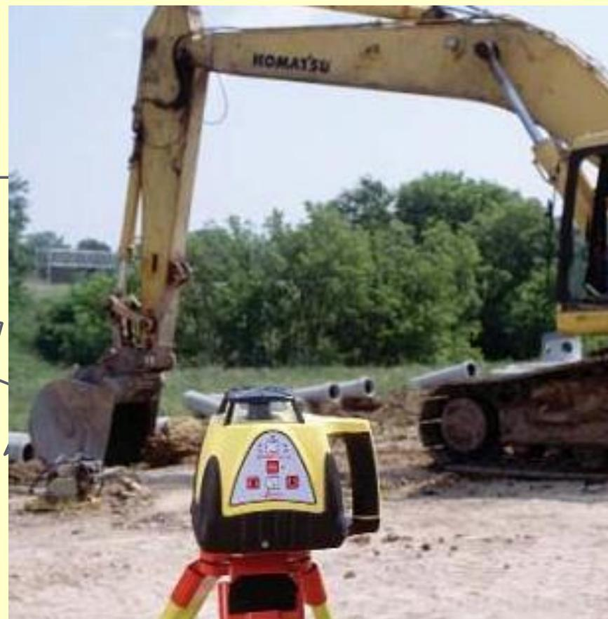
**Nível a Laser utilizado em levantamentos e controle de terraplenagem**
