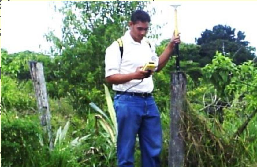
**Trabalho de agrimensura com GPS na determinação de limites de terrenos**
