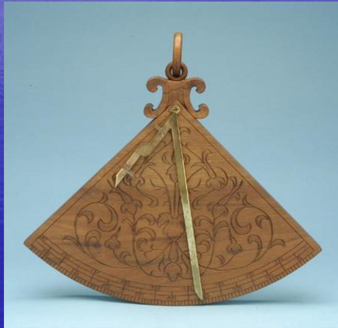
Para utilizá-lo, a pessoa aponta o **quadrante** ao astro que pretende observar, até conseguir ver através dos orifícios de ambas as pínulas. A medição é então encontrada através do valor apontado pelo fio de prumo na escala do quarto de círculo, onde se encontra uma graduação de  $0^{\circ}$  a  $90^{\circ}$ .
