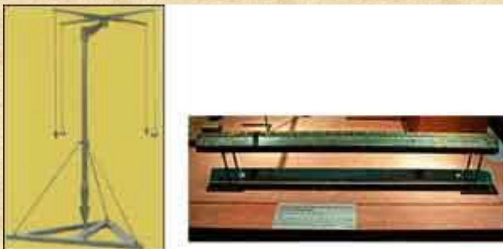
Reprodução da Groma, conservada no Museu de Nápoles, e o codo real.
