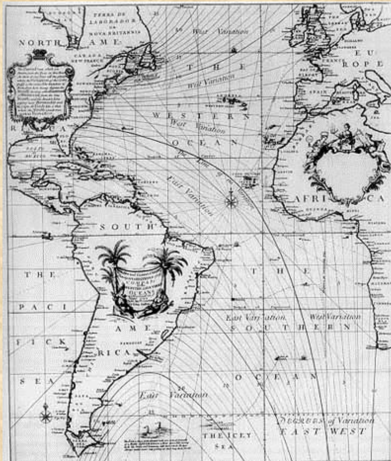
Fragmento do mapa de isogônicas confeccionado por E. Halley na volta da expedição "Paramour Pink", este mapa foi um dos primeiros exemplos de cartografia temática
