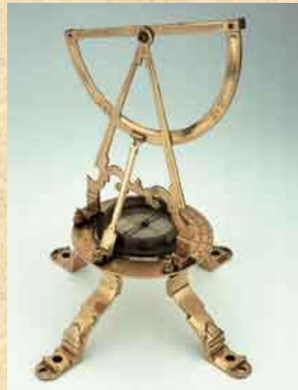
Bússola topográfica rudimentar
