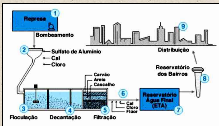
Tratamento de purificação da água
