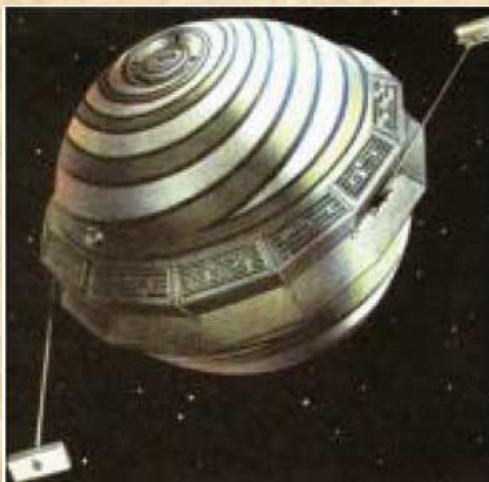
O satélite TRANSIT 1B, o primeiro da série; logo substituído pela constelação GPS.
