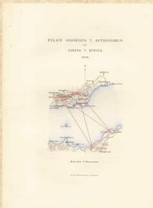
Gráfico do enlace publicado nas Notas apresentadas por Carlos Ibáñez e Miguel Merino a Real Academia de Ciências Exatas, Físicas e Naturais, no ano de 1880.
