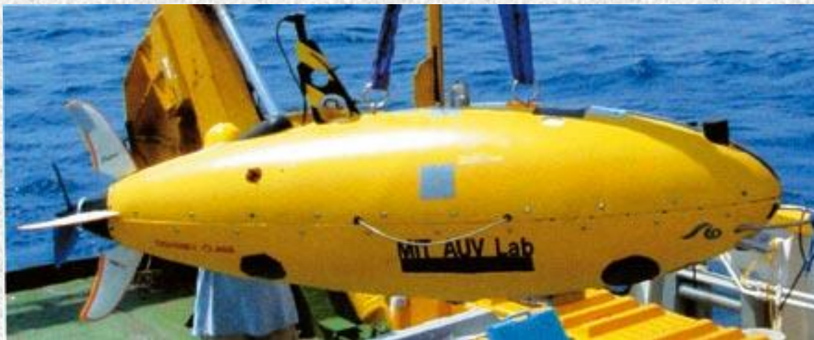
Figura 2: O M.I.T. dos EE. UU., construiu em 2003, para uma expedição a Grécia com sonar lateral de 600 kHz e câmera digital de 1.3 megapixel.
