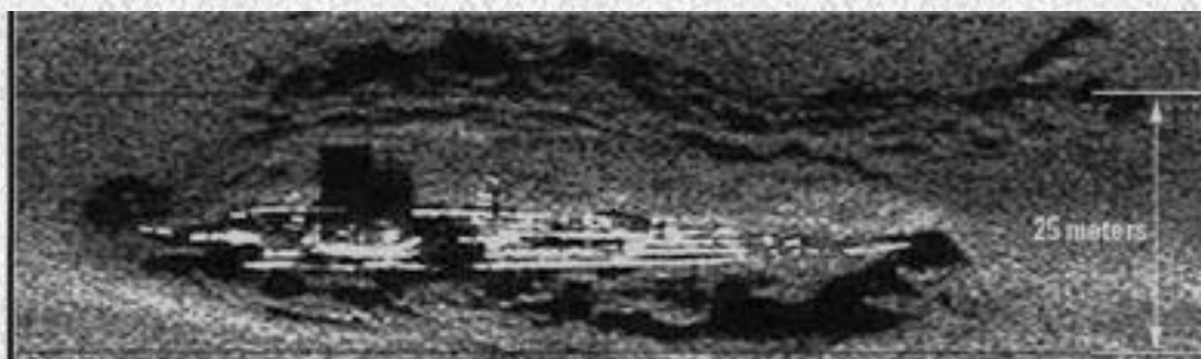
Figura 5: Imagem do sonar lateral do Surveyor: Capta o submarino alemão, U – 166, afundado no Golfo do México, no grande cânion do Mississippi, a 1500 m de profundidade.
