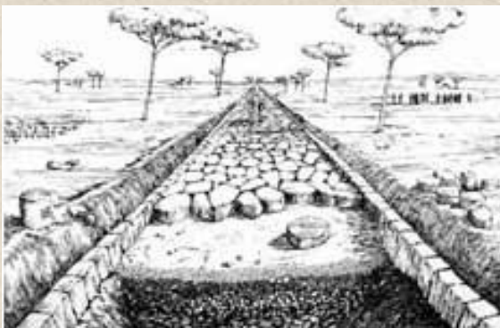
Construção de uma estrada romana
