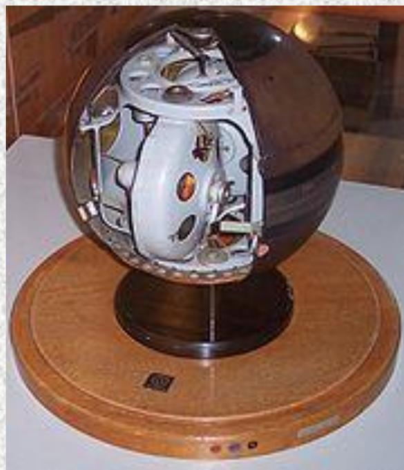
Fig.14 - Bússola Giroscópica
