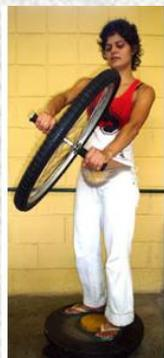
Fig. 12 Coloca-se a roda de bicicleta para girar e pede-se para o visitante alterar a direção do eixo da roda. Quando o visitante assim faz, ele próprio começa a girar em cima da plataforma giratória. Permite discutir a conservação do momento angular, o efeito giroscópico.
