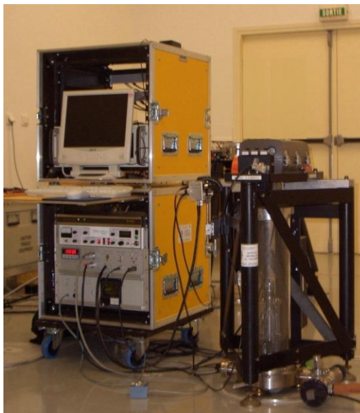
Gravímetro absoluto transportável IMGC-02.
