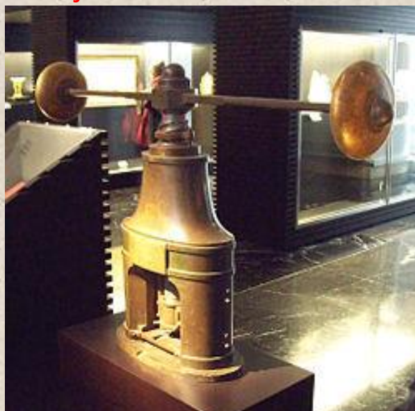
Prensa de volante francês, usada pela Real Casa da Moeda da Espanha no século I
