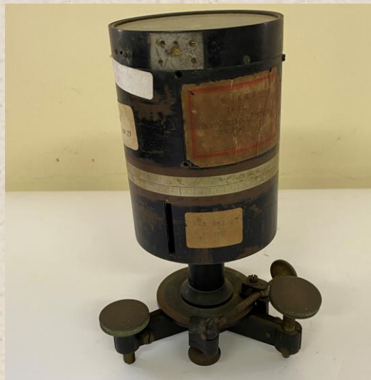
Pantômetro com bússola e parafusos calantes.
