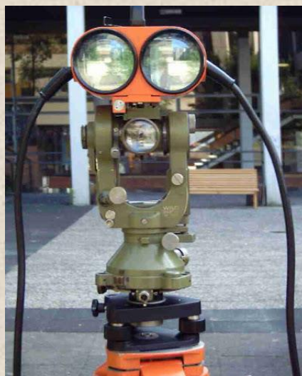
Modelo Wild DI 10, acoplado a um teodolito.
