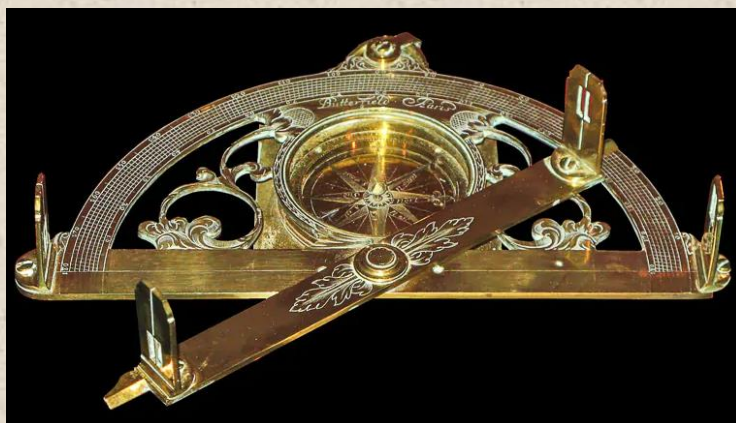
Grafômetro com alidade de pínulas e bússola.
