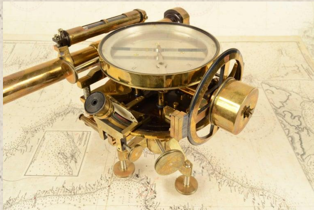
Bússola de agrimensor com limbo vertical.
