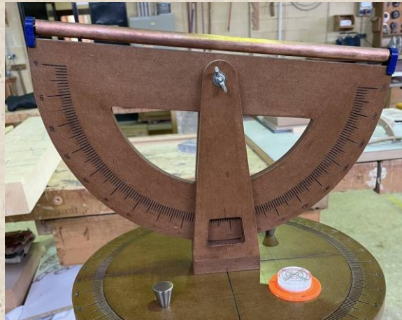
Dioptra, tipo de goniômetro para medida de ângulos horizontais e verticais.
