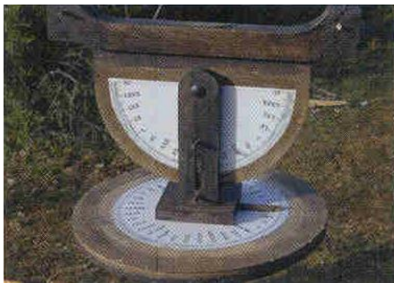
Dioptra com disco vertical e horizontal, para medida de ângulos verticais e horizontais.
