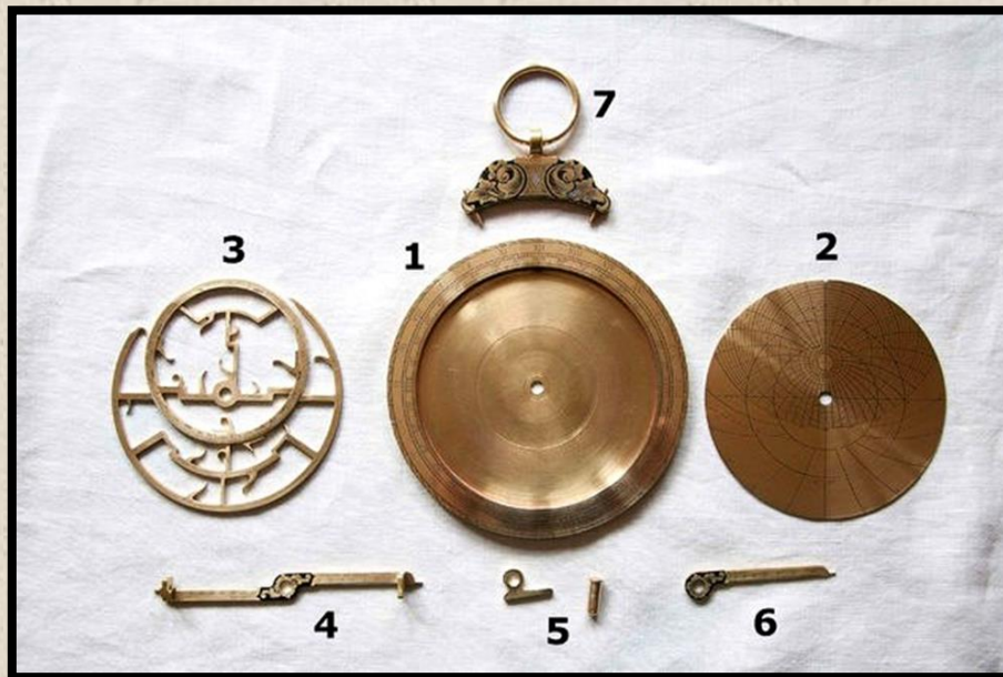
Componentes de um astrolábio
