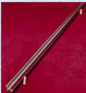
"Metro do Arquivo" - Padrão de referência para comprimento do século XIX até 1985, quando a definição da unidade metro foi alterada, e desde então o metro pode ser reproduzido em laboratório, por meio de um equipamento que utilize um laser estabilizado.
