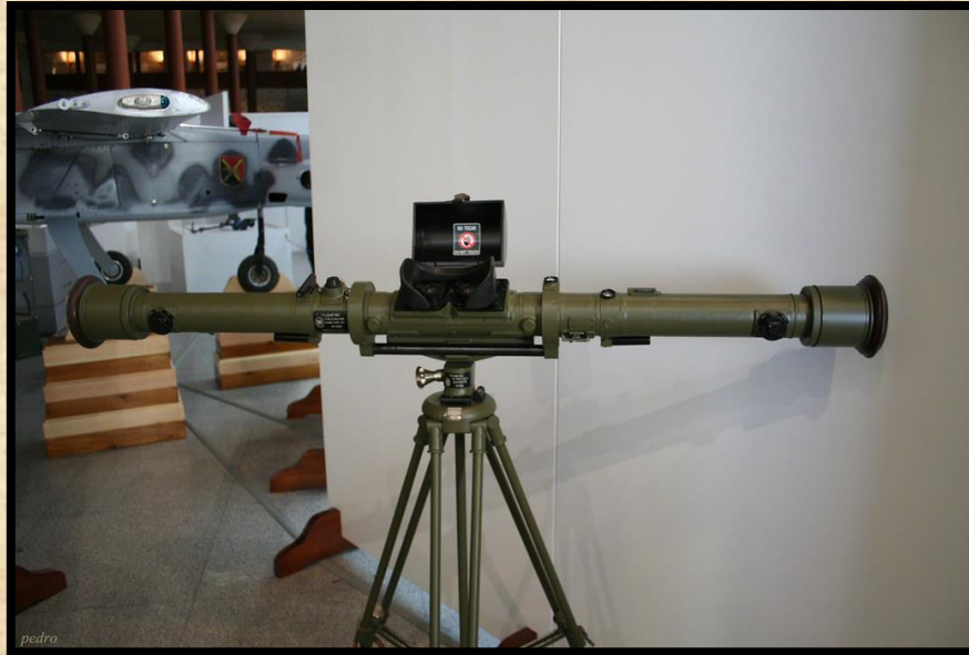
Telêmetro Estereoscópico com 1,24 m de base, fabricado em 1945
